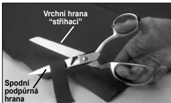
Obrázek 4: Běžné uchopení nůžek při stříhání
