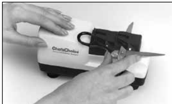
Obrázek 6: Uchopení a broušení nůžek pro praváky.
