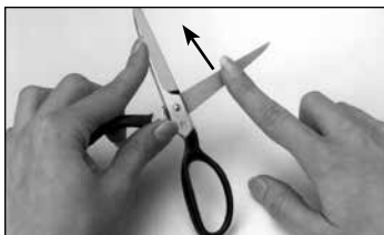
Obr 5: Opatrne nahmatajte ihlu pozdĺž celej zadnej strany čepele. Všimnite si šípku, v smere ktorej máte pohybovať prstom po čepele.
