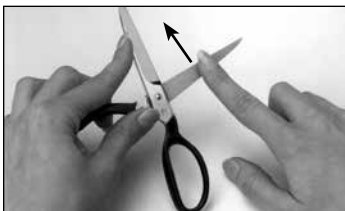
Obrázek 5: Zjištění vytvoření zalomení na hraně ostří. Projedte prstem ve směru šipky.
