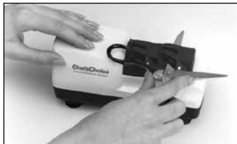
Obr 6: Odporúčané držanie nožníc pre pravákov.
